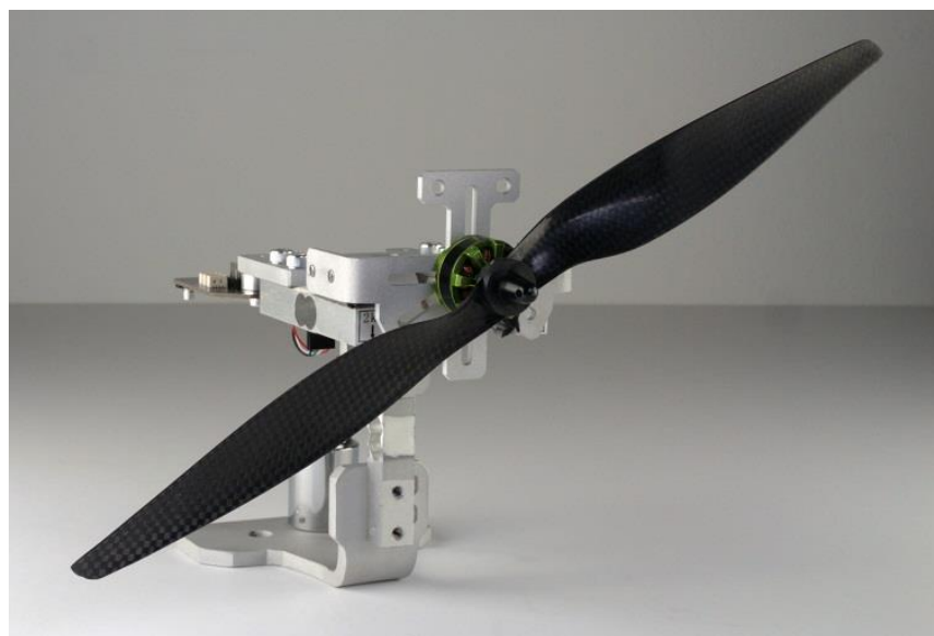
图 专业动力系统测量装置RCbenchmark-1580 2
