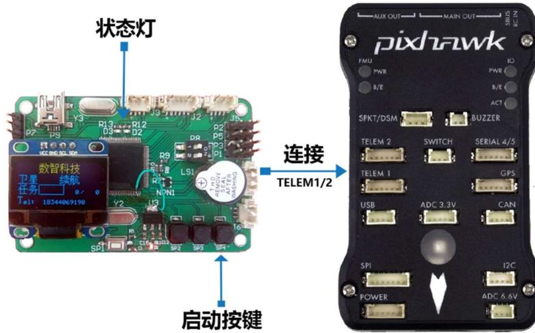
提示：正确连接断点续喷模块，蓝色状态灯会持续闪烁。
