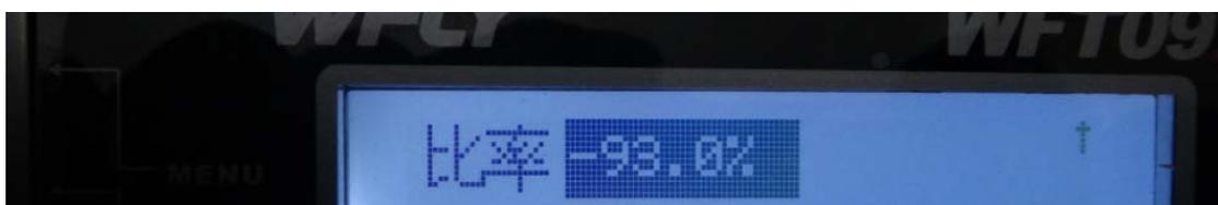
**模式二 PWM 配置：**接下去把开关 C 打回 2 的位置，把开关 B 打到 1 的位置，进入可编程混控 2，按下图配置遥控器，最后一个比率仍旧对着屏幕调，按加键加大比率，看着屏幕加到 1295 完成第二模式的 PWM 设置，一般是加到+37%
