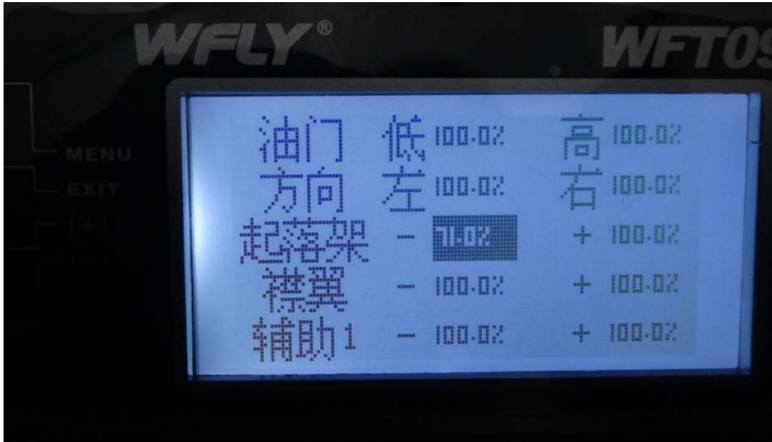
**2、模式四 PWM 配置：**把 C 开关打到 0 位置，回到遥控主菜单页面，选择高级设置——可编程混控 1，按下图设置遥控器，最后一个比率仍旧对着屏幕调，将比率百分比降低，看着屏幕降到 1555 完成第四模式的 PWM 设置，一般是比率—93%，你会发现 MP 跳到了第四模式
